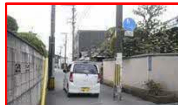
2-15 電柱が進行の妨げになっている例
