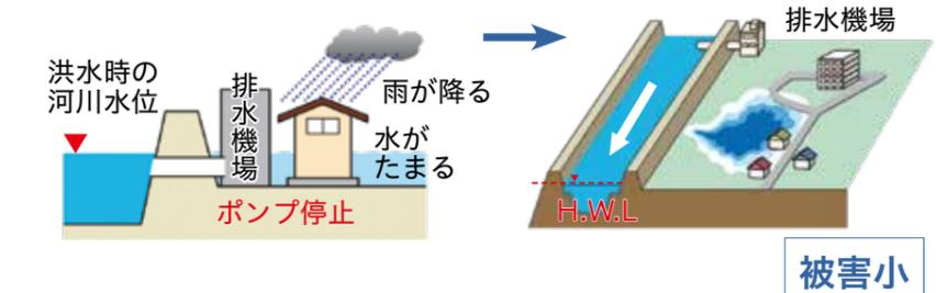
堤防が耐えられる最高の水位。河川の水位がH.W.Lを超えると堤防が決壊したり、水があふれたりする危険があります。
