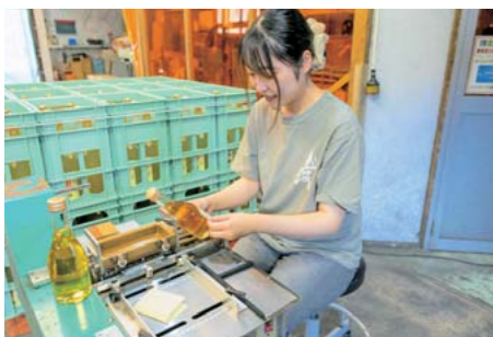
▲最終工程のラベル張り。瓶内に異物が入っていないかの確認も大切な作業
