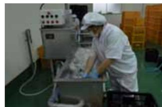
生産組合から納品されたキクラゲは、まず洗浄機へ。泡の中でキクラゲを躍らせ、細かな汚れを落とす
