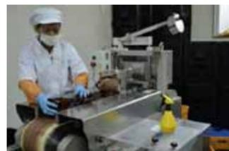
洗浄後、スライス用のキクラゲは裁断機へ通し、自動で3cm幅にカットしていく。15kgを約4分で処理
