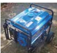
▲可搬型非常用発電機
