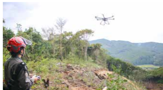
▲ドローンを使い、シカの食害防護柵の材料を運搬
