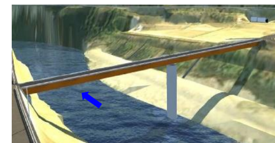
大瀬橋【鋼2径間連続鋼床版箱桁橋】
