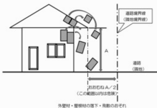
① 外壁材や屋根材の落下等
