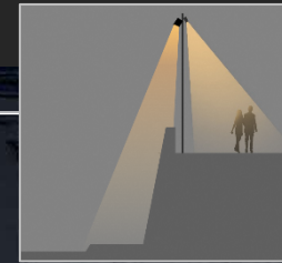
護岸上道路からの スポットライトポールによる投光
