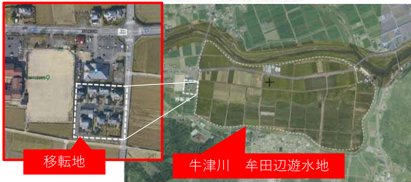
5 遊水地 【面積52.4ヘクタール・遊水量約90万m³】 大洪水のときには、この区域に一時的に水を貯め、下流の被害を減らします。
