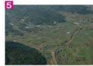
5 遊水地 【面積52.4ヘクタール・遊水量約90万m³】 大洪水のときには、この区域に一時的に水を貯め、下流の被害を減らします。
