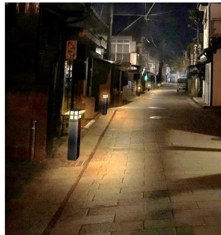
暗さの払しょくには、排水溝暗渠を利用して低ポール灯を設置する方法もある。
