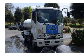
散水車による散水作業
