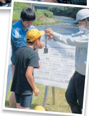
▲透視度計で水の透明度測定
